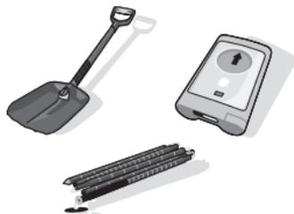
I localizzatori a.r.t.va sono realizzati per aiutare al ritrovamento veloce di un travolto in incidente di valanga.
