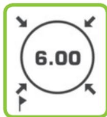
La marcatura di un trasmettitore è possibile fino ad una profondità di ca. 7 m. In caso di travolti a profondità maggiori, la localizzazione viene determinata stabilendo l'indicazione della distanza minore.
