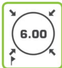
Le marquage d'un émetteur est possible jusqu'à une profondeur d'environ 7 m. Si la victime est ensevelie encore plus profondément, elle peut être localisée en déterminant l'affichage d'éloignement le plus faible.
